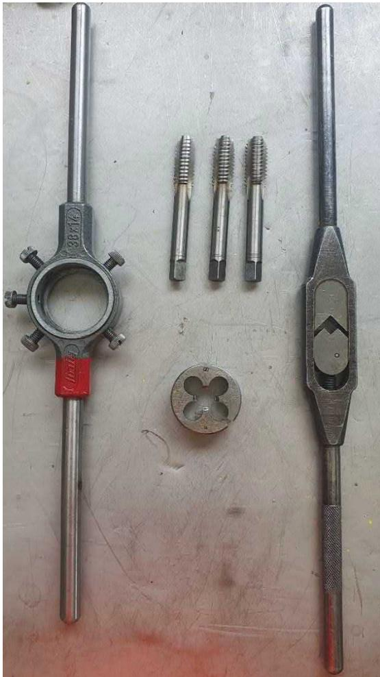
Figure 9 : Outils pour filetage & taraudage
