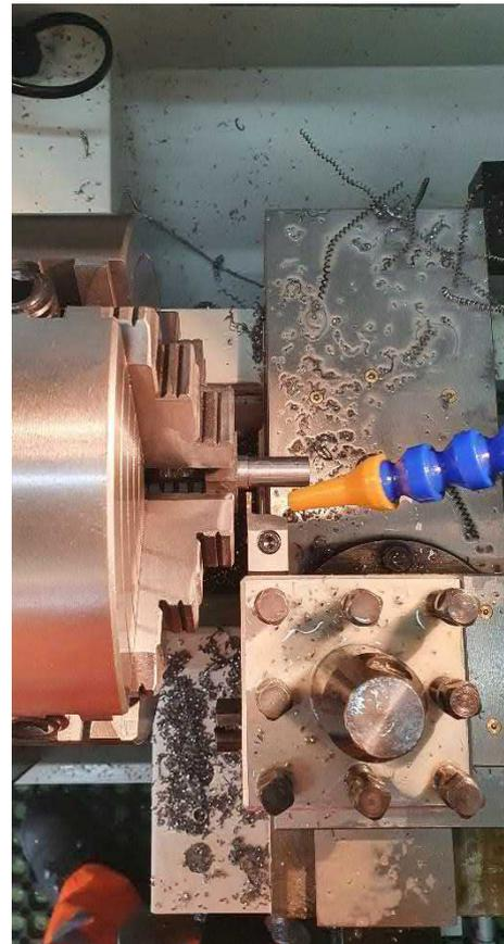
Figure 12 : Tournage des diamètres sur Pos. 1
